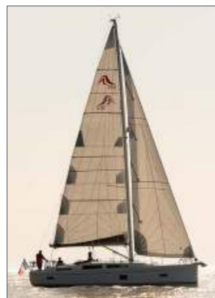
▲ Le mât du Hanse 388, avec 60 cm de plus que celui du 380, fait un gréement élancé.
