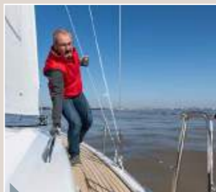
Le bas-hauban frappé sur le livet entrave un peu les déplacements vers l'avant.
