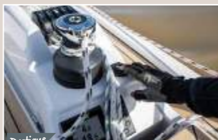
Le barreur a la main sur les deux pianos en bout d'hiloire et peut utiliser les winches motorisés.
