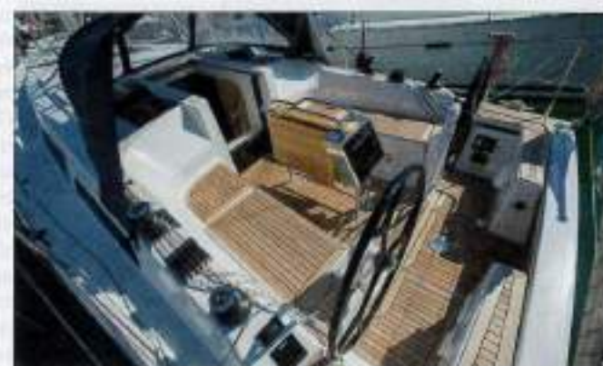
▲ Le cockpit se veut moderne : du teck pour l'esthétique, deux barres à roue pour le confort en mer et une table repliable de bonne facture !
