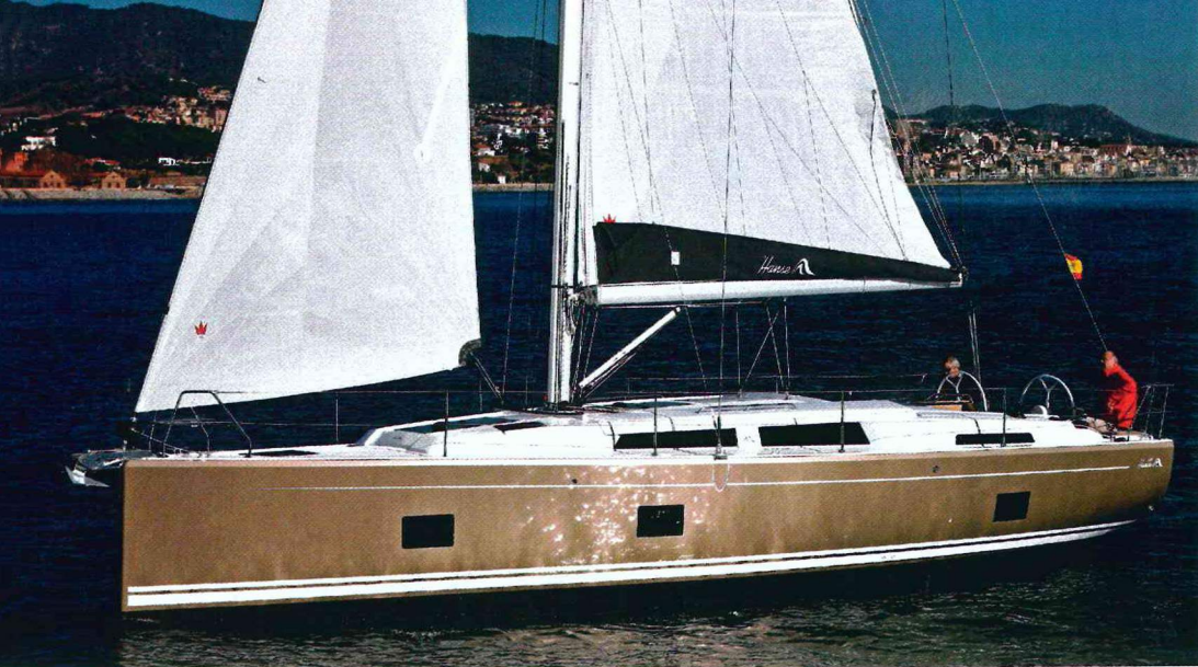
18. El Hanse 418 aparece mayor de sables forrados o enrollable en el palo, foque autovirante y gennaker. Una configuración cada día más popular en embarcaciones de crucero puro.
