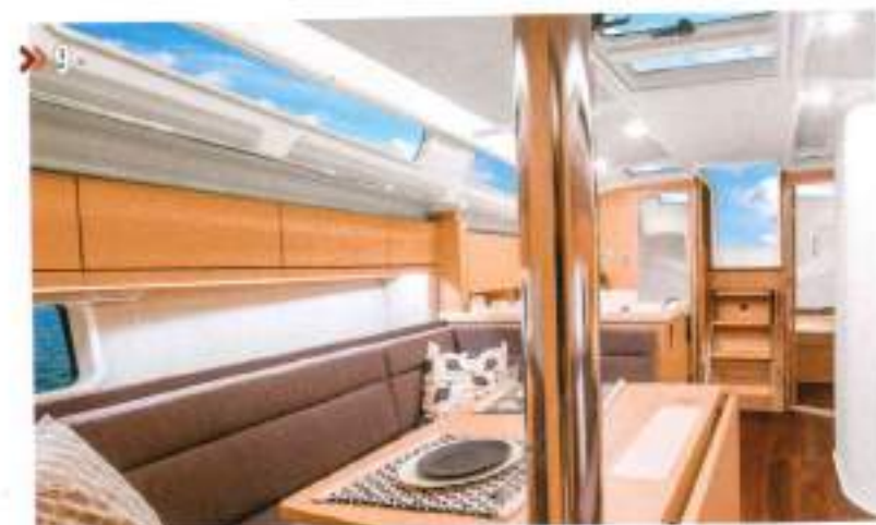
8. La luz natural entra en el salón por las ventanas del casco y de la caseta, las escotillas cenitales y las ventanas a ambos lados del tambucho.
