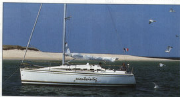
Etrave droite et grande longueur à la flottaison caractérisent le Dehler 29.
